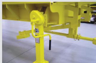
**Manual:** A elevação e o nivelamento manual de 1.300 a 1.750 mm com duas velocidades.
