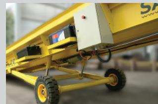
**Bateria:** Acionamento autônomo através de comando eletro-hidráulico por bateria.
