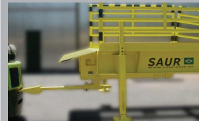
Incorpora suporte para ser rebocada pela própria empilhadeira ou outro carro rebocador. O suporte é oscilante para reduzir os impactos com o solo e possui comprimento ajustável.
