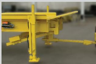
Função hidráulica adicional para regulagem dos pés de apoio.
