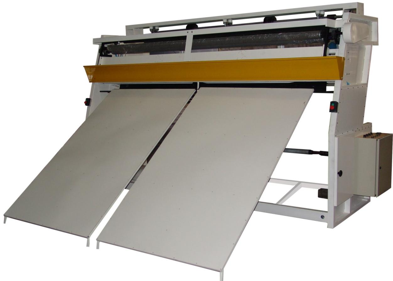
A Máquina de Cortar Tecidos Acolchoados Mutinga é equipada com sistema de corte por rampa com sensor, que assegura precisão do corte. Também possui comando eletrônico com CLP que proporciona facilidade na operação.
