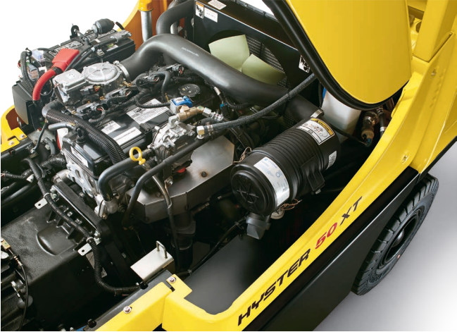
Motor PSI 2.4L - Dois modos de operação.
