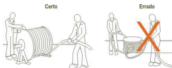
Figura 9 - Manuseio do cabo de aço
